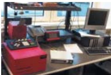
Die Test- und Befüllungsstation für die „Lotto-Router“ mit einem der beiden „Ammen-PCs“
